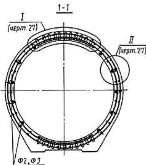
*Деталь армирования стенки трубы*
