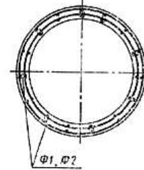
*Деталь армирования стенки трубы*
