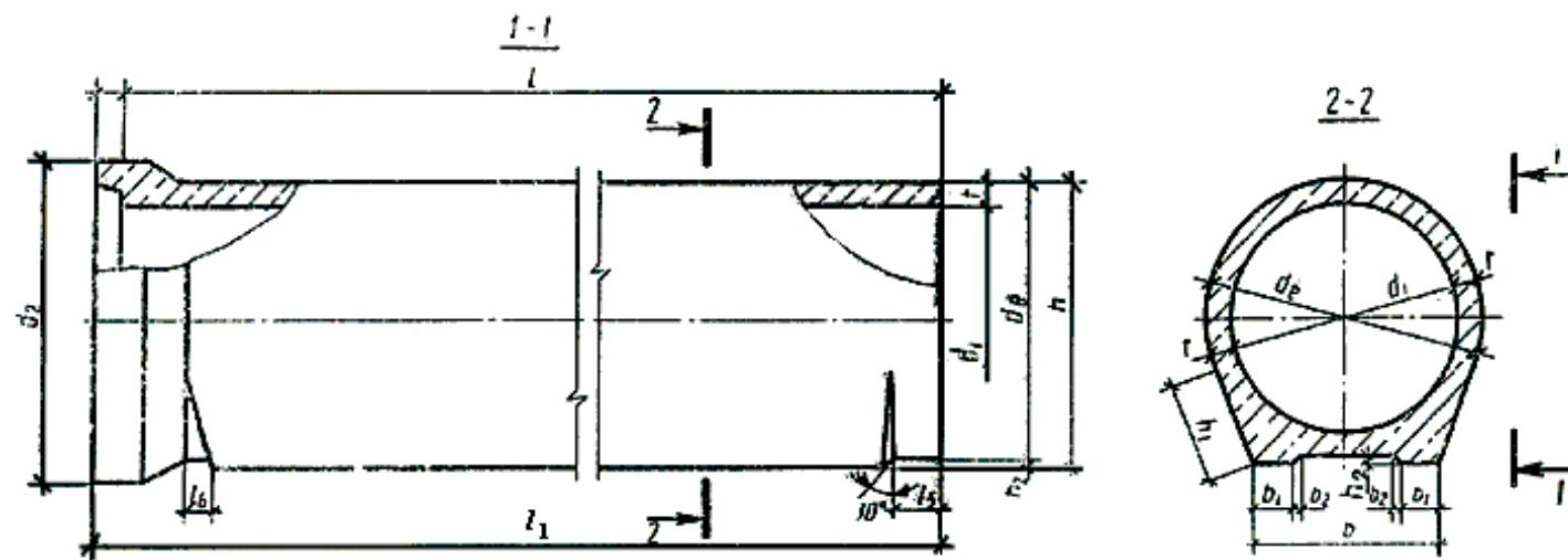
Продольный разрез стеники трубы
