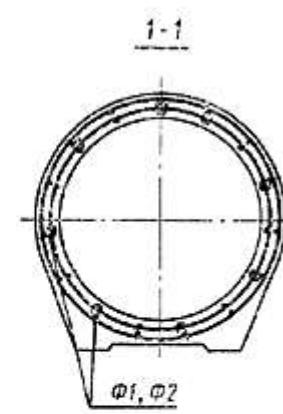
Деталь армирования стенки трубы
