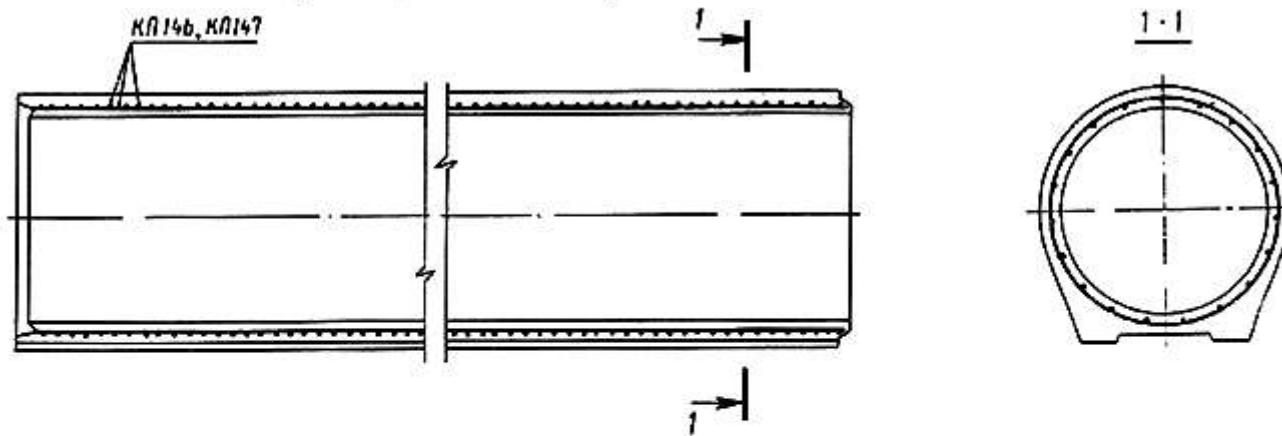
*Деталь армирования стенки трубы*
